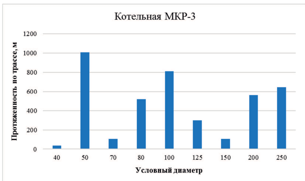
Рисунок 5 – Структура тепловых сетей от котельной МКР-3
