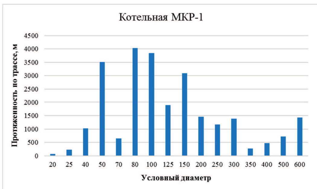
Рисунок 4 – Структура тепловых сетей от котельной МКР-1
