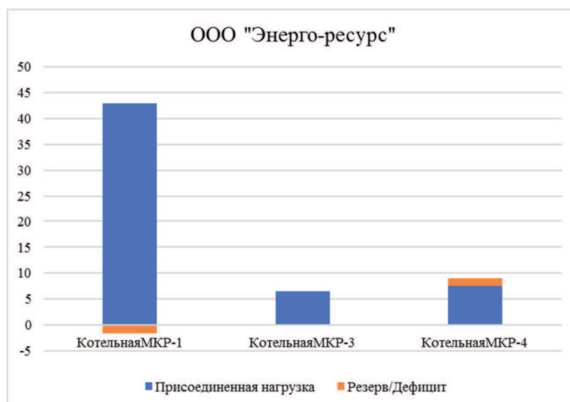
Рисунок 24 – Значения резервов/дефицитов тепловой мощности нетто ООО "Энерго-Ресурс"
